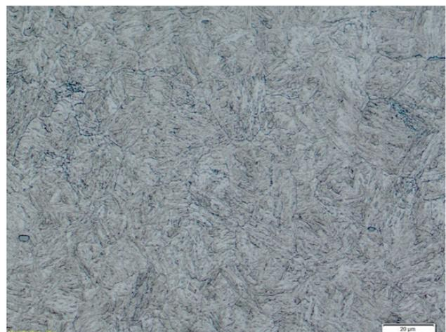
**Fig. 5 - Microstruttura dell'acciaio (18NiCrMo14-6) della prova 4 (D 4-1)**
